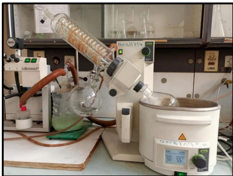
Figure 29: Evaporation de l'extrait \text{CH}_2\text{Cl}_2 par l'évaporateur rotatif
